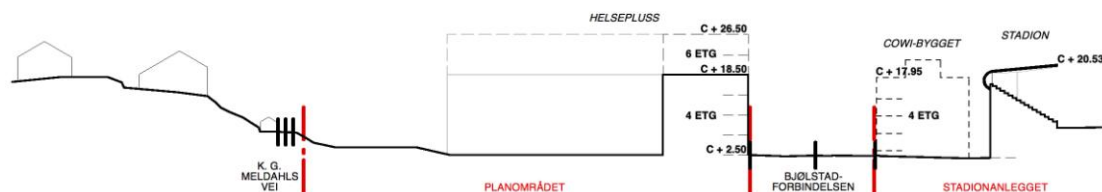
Terrengsnitt med etasje- og kotebegrensninger
